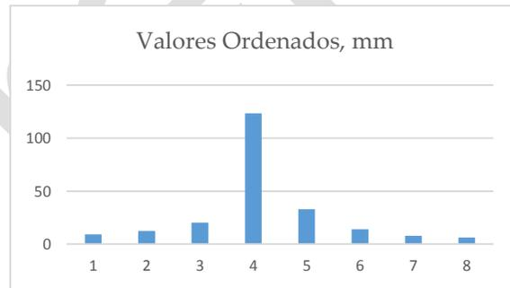
Figura 7. hietograma para intervalos de 30 minutos y duración total de 4h.
