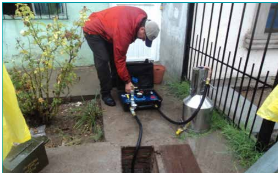
Figura 6.2. Evaluación del rendimiento de medidores en sitio.
