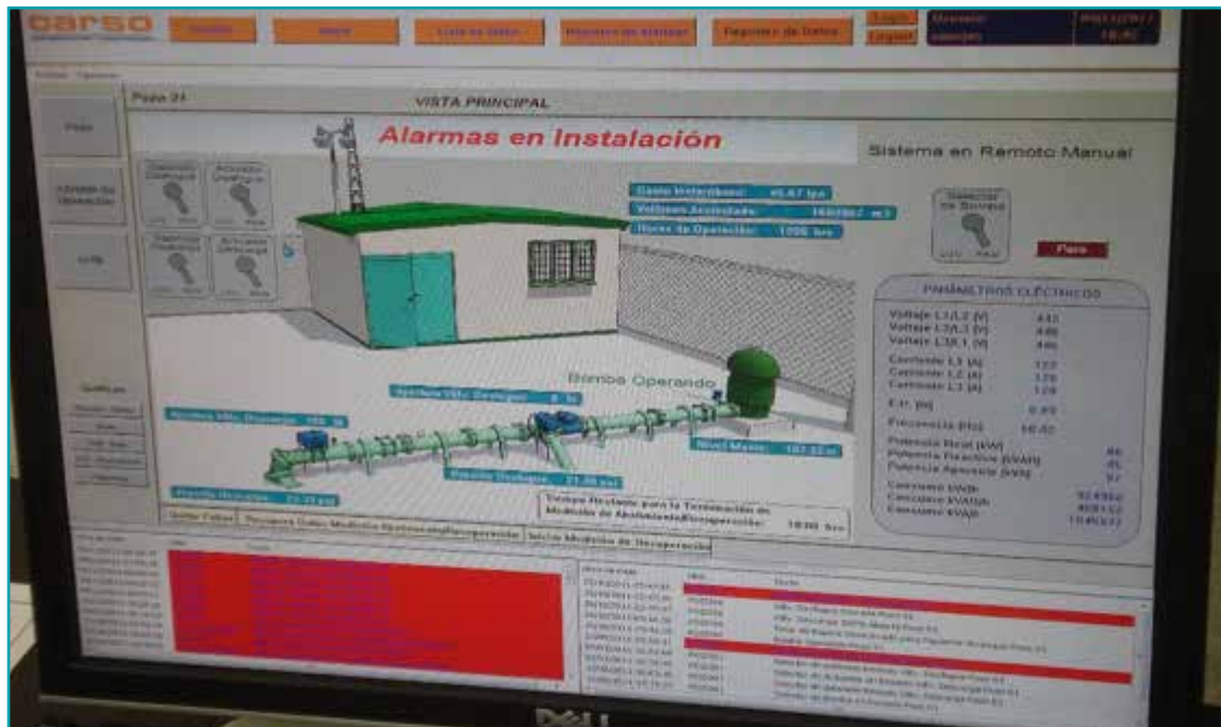
Figura 4.3. Presentación de datos instantáneos, eléctricos y de flujo, en tiempo real de un pozo; sistema operacional de la JMÁS Juárez. Foto propia
