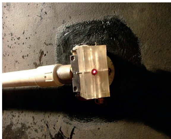
Figura 3.37 Alineamiento de sensores con rayo láser.
