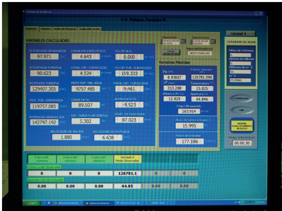
Figura 2.74 Despliegue del Monitoreo de variables relativas al sistema de medición.
