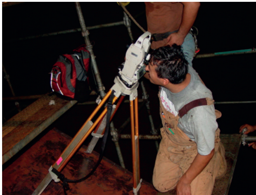
Figura 2.22 Ubicación de sensores en la pared del conducto por medio de teodolito.
