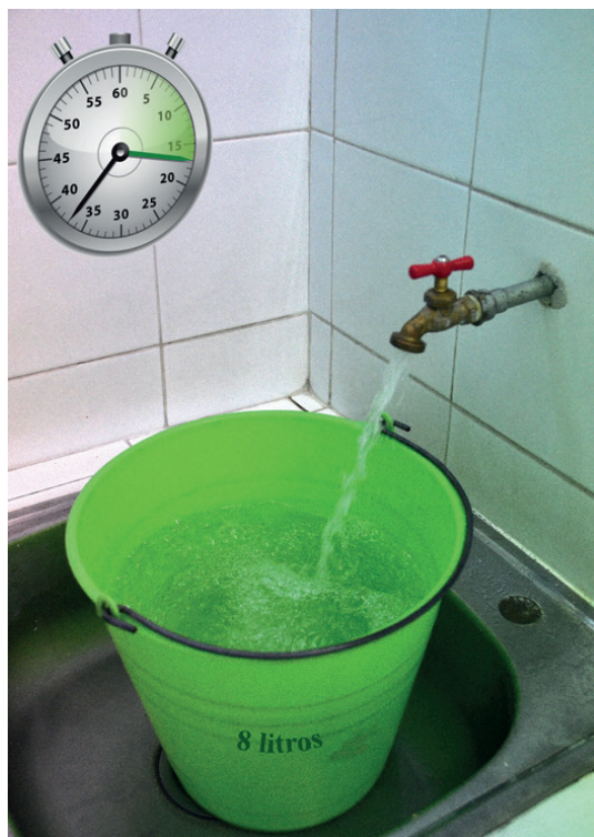
Figura 4.2 Determinación indirecta del gasto.
