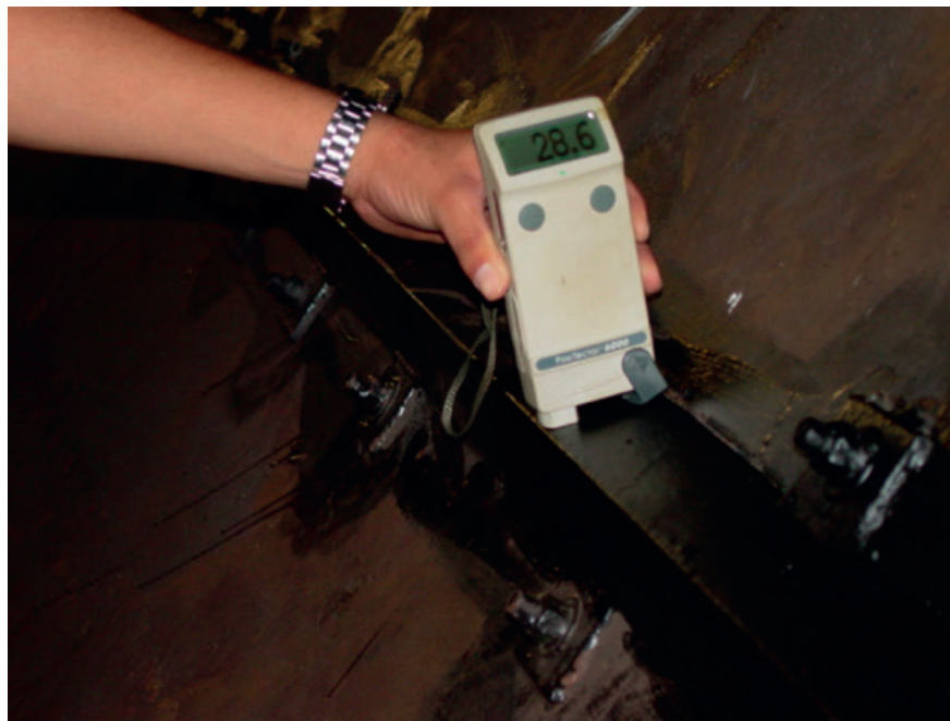
Figura 2.44 El espesor mínimo requerido del recubrimiento es de 16 milésimas de pulgada.
