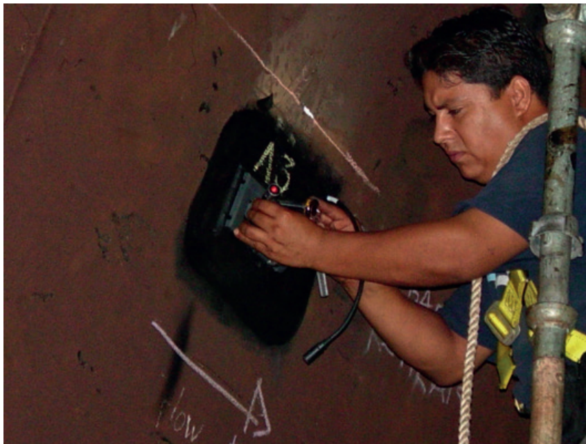
Figura 2.49 Ajuste de la alineación del Sensor.
