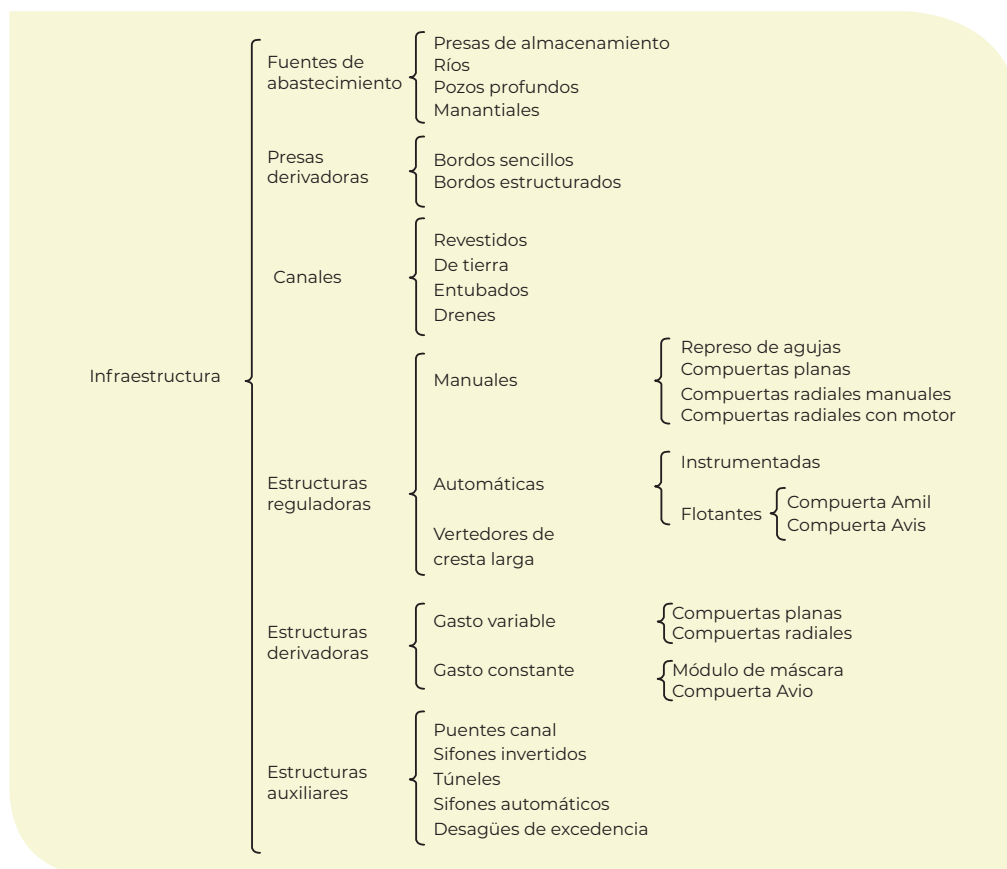
Figura 7.1. Infraestructura para la operación de canales de riego.
