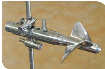
Figura 6.3. Molinete de hélice marca Hydrologycal Services.
