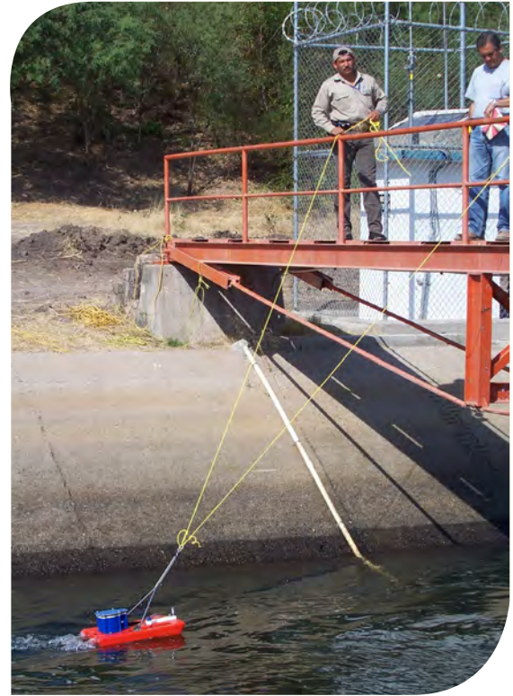
Figura 6.10. Aforador acústico Doppler flotante operado desde un puente rígido de metal.
