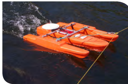
Figura 6.11. Dos modelos de aforadores acústicos Doppler flotante.
