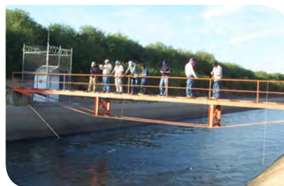
Figura 6.4. Aforos en la salida de la presa Josefa Ortiz de Domínguez. Fotografía: Serge Tamari.
