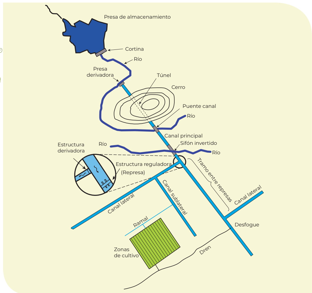
Figura 1.1. Esquema simplificado de un DR.
